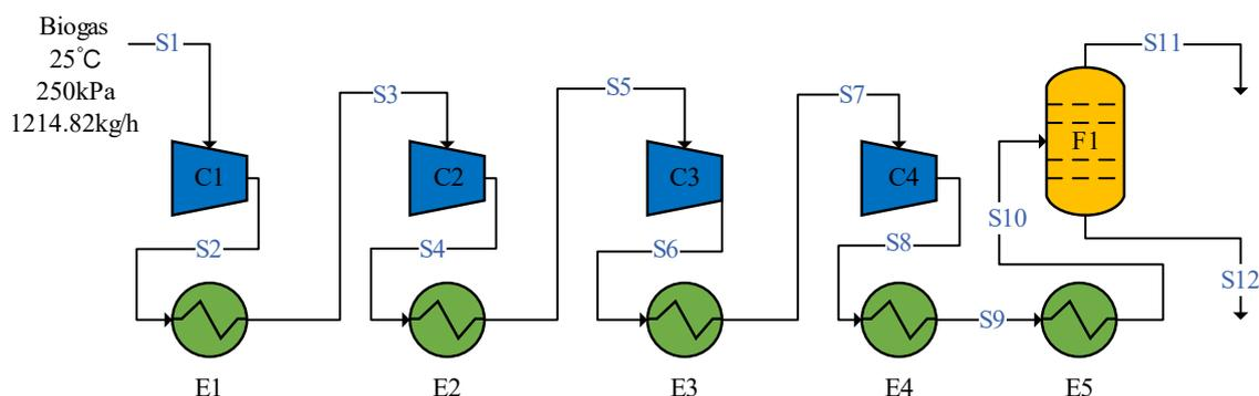
F-Flash; C-Compressor; E-Cooler; S-Stream
